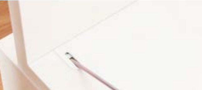
Połączyć elementy mebla wkrętką akumulatorową i narzędziem Cabineo. Prosta, szybka praca z wstępnie ustawionym momentem obrotowym ok. 2.5 Nm.
